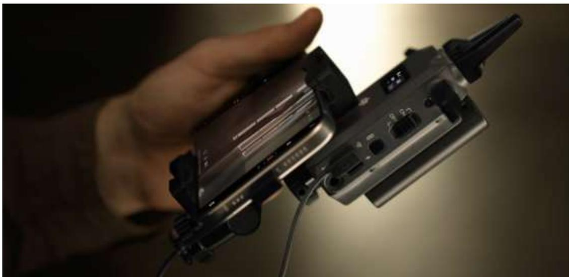
*Construida en base a la tecnología de radio definida por software, DJI SDR Transmission usa los modos de transmisión de vídeo por SDR y por Wi-Fi. La tecnología SDR lleva la capacidad de transmisión de vídeo a un nivel superior, al ofrecer mejor estabilidad, resistencia a interferencias y penetración. Para las situaciones que requieren monitorización provisional, DJI SDR Transmission también incorpora transmisión por Wi-Fi para ofrecer más flexibilidad a los equipos de rodaje.*
